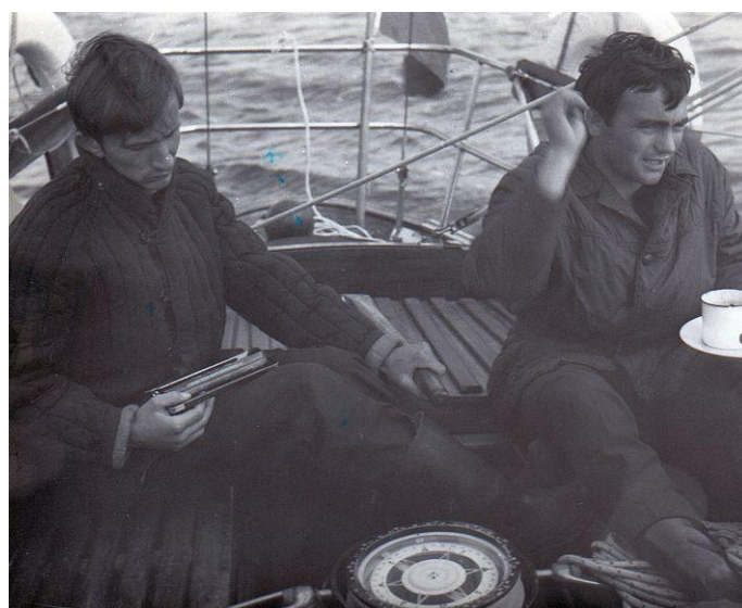
Fot.12. Sprawdzanie wpływu „ tranzystora ” na dewiację kompasu sterowego
